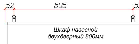
После монтажа навесных шкафов на место и регулировки общего уровня соедините шкафы между собой межсекционными стяжками, предварительно просверлив под них отверстия.
